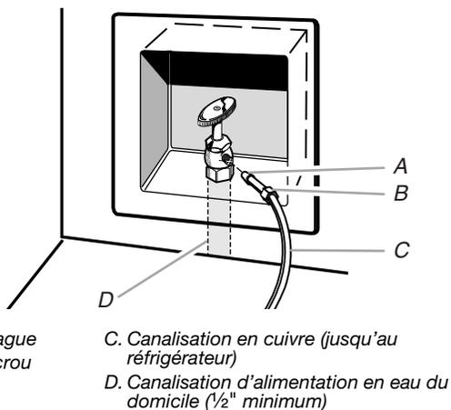
4. On est maintenant prêt à connecter le tuyau en cuivre au robinet d'arrêt. Utiliser un conduit de cuivre flexible de 1/4" (6,35 mm) de diamètre extérieur pour raccorder le robinet d'arrêt au réfrigérateur.
