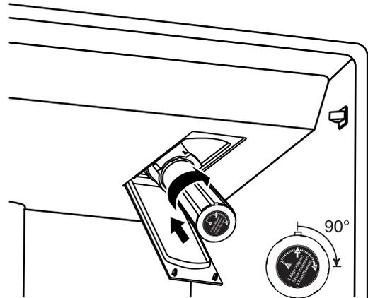
6. Tout en gardant le clapet du compartiment ouvert, soulever le filtre pour l'insérer dans le compartiment. Ensuite, fermer complètement le clapet du compartiment du filtre.
