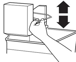
**REMARQUE :** Éteindre la machine à glaçons avant de retirer le bac d'entreposage à glaçons pour servir des glaçons ou pour nettoyer le bac. Ceci empêchera les glaçons de tomber de la machine à glaçons et dans le compartiment de congélation. Après avoir réinstallé le bac d'entreposage, mettre en marche la machine à glaçons.
