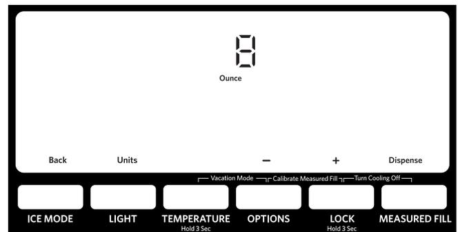
Appuyer sur le bouton d'ICE MODE (mode glaçons) sous Back (retour) pour désactiver manuellement la caractéristique de remplissage mesuré et revenir à l'écran d'accueil.
