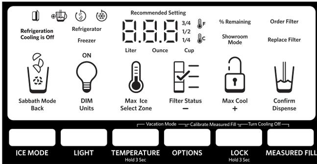
**IMPORTANT :** L'écran d'affichage sur le tableau de commande du distributeur s'éteint automatiquement et entre au mode "veille" lorsque les boutons de commande et les plaques du distributeur n'ont pas été utilisés pendant au moins 2 minutes. Appuyer sur n'importe quel bouton du tableau de commande pour activer l'écran d'affichage. L'écran d'accueil apparaît tel qu'illustré.
