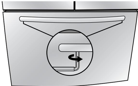
12. En tournant la clé de gauche à droite, serrer la vis de blocage d'un quart de tour à la fois, jusqu'à ce qu'elle commence à toucher la vis à épaulement. Ne pas serrer complètement.
